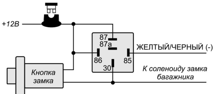
**Внимание!** Подсоединение ЖЕЛТОГО/ЧЕРНОГО провода непосредственно к силовым цепям замка багажника или к некоторым устройствам дистанционного запуска двигателя приведет к повреждению основного блока системы.
