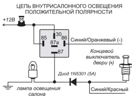
**Внимание! Обязательно используйте диод для изолирования цепи управления внутрисалонным освещением от цепи триггера двери. В противном случае не сможет правильно работать функция пассивной постановки на охрану и функция автоматической повторной постановки системы в режим охраны.**
