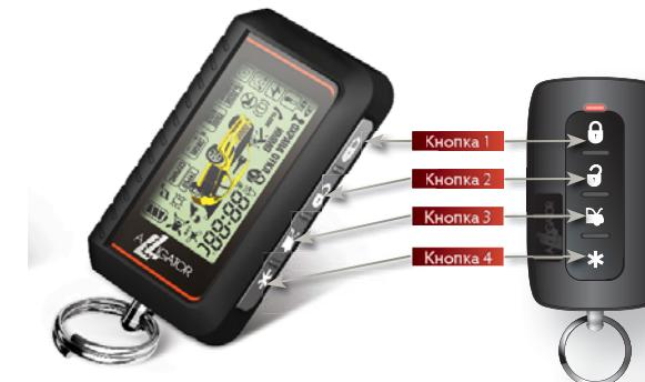
Брелоки-передатчики позволяют управлять всеми функциями системы. Помимо этого, каждый раз при использовании передатчиков система будет посыпать специальные сигналы, подтверждающие исполнение той или иной команды ("обратная связь"), а встроенные в брелоки-передатчики миниатюрные динамики будут подавать соответствующие звуковые сигналы подтверждения. Кроме этого, на ЖК-дисплее 5-кнопочного брелока будет появляться соответствующая индикация
